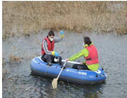
Las muestras de sedimentos del fondo de las lagunas se extraen con una draga *Van Veen* de acero inoxidable de 0.5 litros de capacidad. Posteriormente, el material extraído es depositado en bolsas de plástico numeradas. Las bolsas se transportan en una nevera refrigerada para ser trasladadas al laboratorio en donde se lleva a cabo la limpieza de los sedimentos. Una vez en el laboratorio, las muestras se depositan en un juego de 3 tamices en serie de diferentes tamaños de luz
